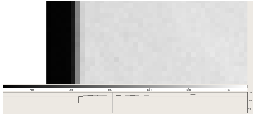
Figura 3.27: Ampliación de imagen de LED derecho. Arriba la imagen, abajo una gráfica mostrando el número de cuentas en cada píxel, en una fila cualquiera.
