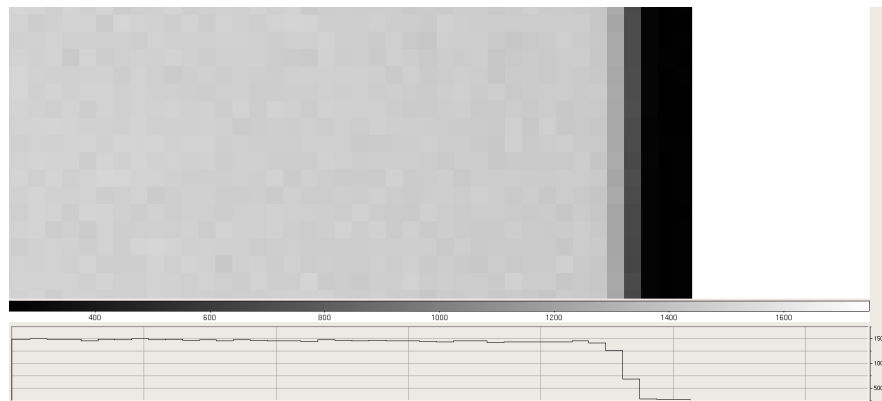
Figura 3.28: Ampliación de imagen de LED izquierdo. Arriba la imagen, abajo una gráfica mostrando el número de cuentas en cada píxel, en una fila cualquiera. Esta es una de las imágenes utilizadas para calcular la CTI_X .
