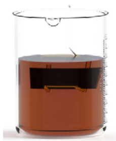
Figura 59. Montaje del ensayo de corrosión por picadura. Fuente: elaboración propia.
