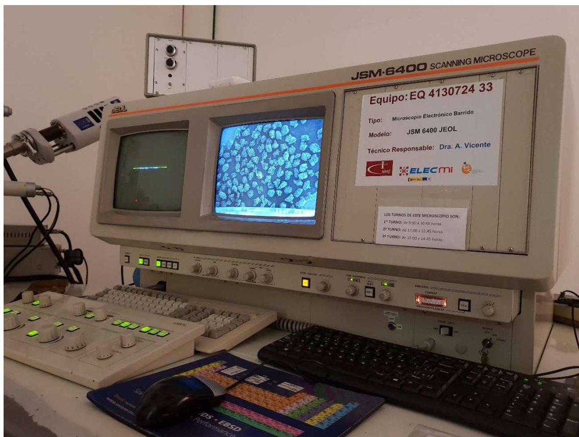
Figura 25: Microscopio electrónico de barrido con imagen de muestra analizada. Fuente Eva Navarro Ruiz.
