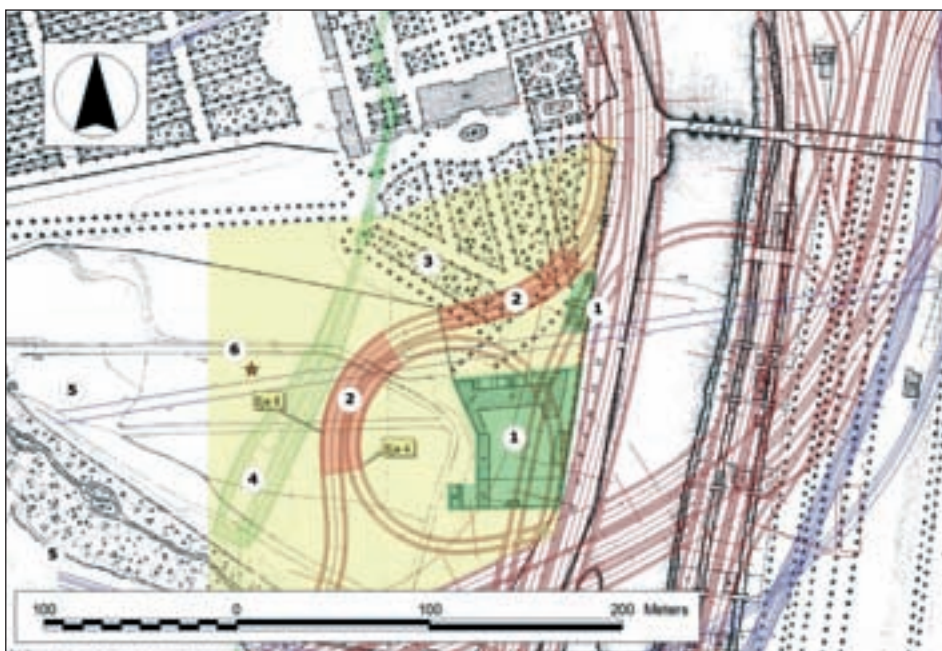
Figura 3. Anexo al documento de Resolución de Autorización de Obras, en el que se prescribe la realización de catas-sondeo para constatar la aparición de estructuras históricas conocidas: 1. Casa de los Empleados. 2. Superficie afectada por la excavación de los ramales. 3. Superficie de ocupación de la obra. 4. Traza del colector Saavedra-Fajardo, realizada durante los años 2001-2003. 5. Galerías correspondientes a la red de Metro de Madrid. 6. Posición del yacimiento paleontológico hallado durante las obras de excavación de la línea 10 de la red de Metro de Madrid.
