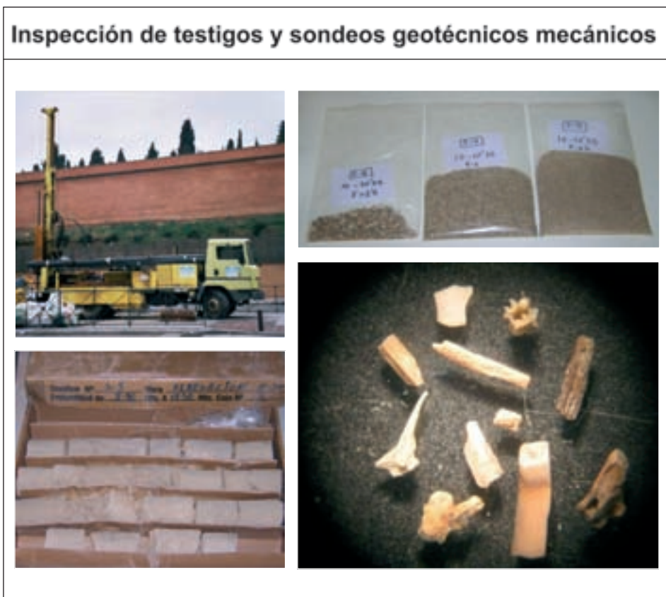
Figura 8. Los sondeos geotécnicos completan el conjunto de los estudios previos y su inspección se ha demostrado una valiosa herramienta para conocer los materiales que serán afectados por la obra: en la figura, resultado de los análisis micropaleontológicos de los testigos mecánicos.
