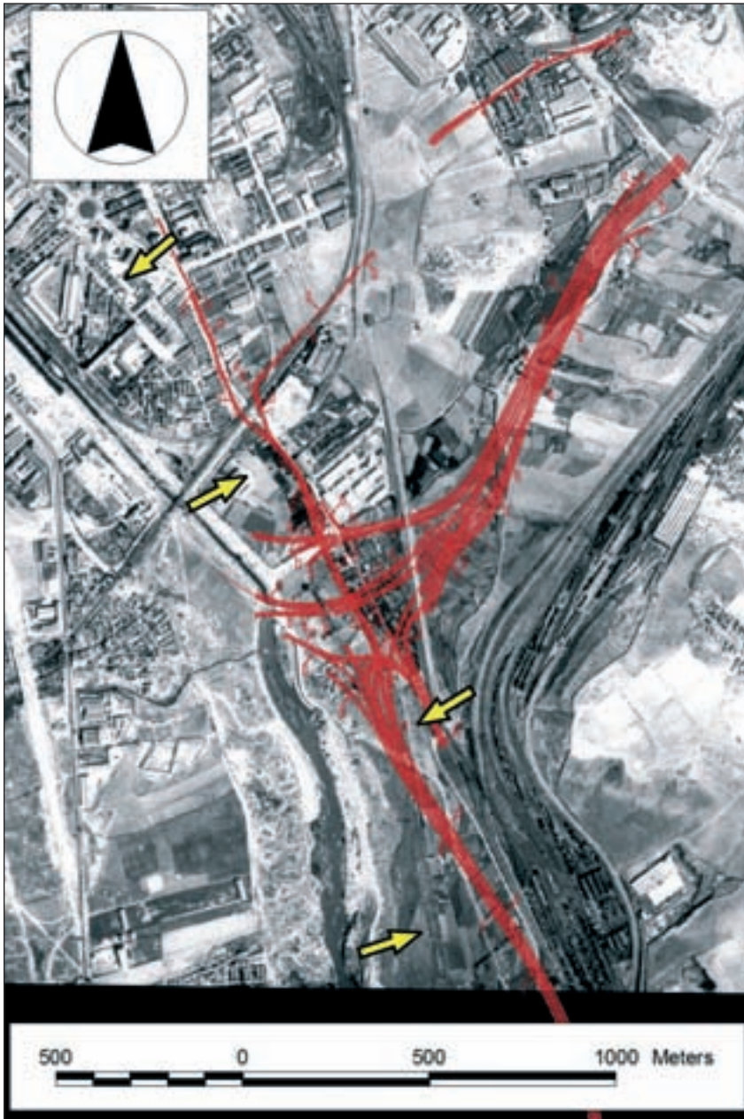
Figura 4. La fotografía aérea vertical se ha demostrado una herramienta muy eficaz en la detección de construcciones contemporáneas. En esta figura se observa la posición ocupada por el Real Canal del Manzanares, visible a pesar de su colmatación durante el segundo cuarto del siglo XIX.
