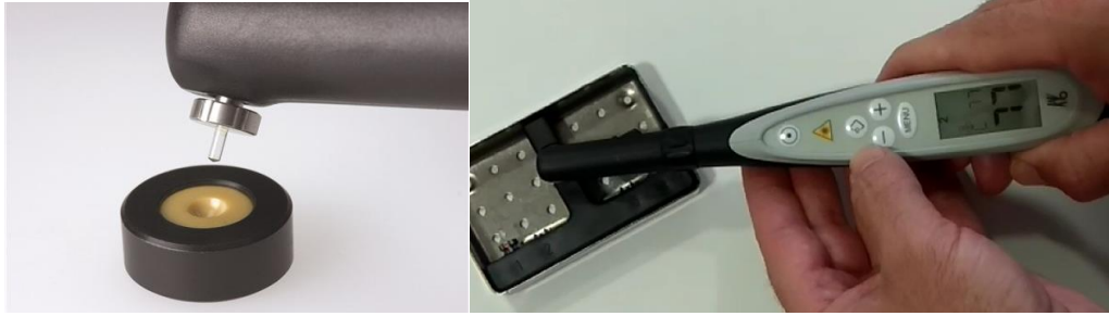
Fig. 15. Calibración DIAGNOdent ® Pen 2190 (Kavo, Biberach an der Riss, Germany) mediante disco de cerámica.
