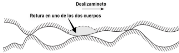
Figura 1-26: Esquema de rotura durante el cizallamiento [32]
