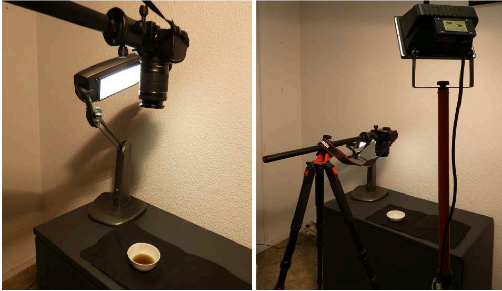
Figura 2-26: Iluminación complementaria de la fotografía en crisol
