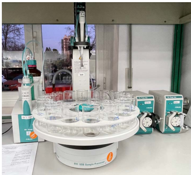
Figura 2-10: Equipo utilizado para medir el número de acidez total
