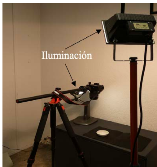
Figura 2-47: Doble sistema de iluminación
