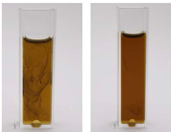
Figura 2-65: Cubetas con muestra de aceite en la que se ven contaminantes
