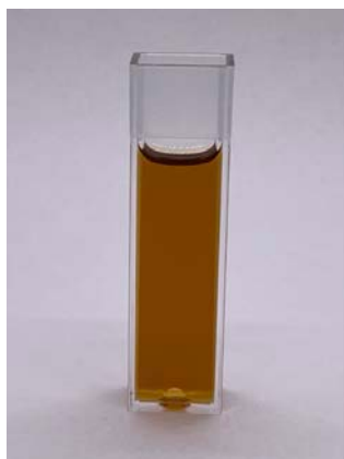
Figura 2-62: Muestra de aceite contenido en la cubeta transparente Kartell LABWARE para espectrofotometría
