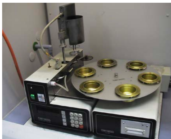
Figura 2-8: Equipo electrónico Herzog Automatic Flash Point Cleveland (ASTM D92)
