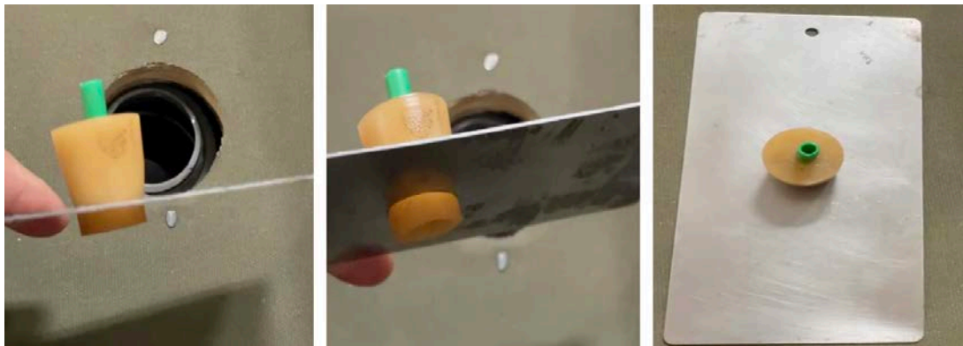
Figura 2-71: Sistema para cubrir el recipiente contenedor de la muestra de aceite y la introducción de la cámara endoscópica
