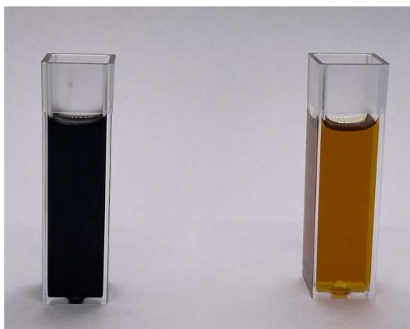
Figura 2-68: Cubeta rellena con aceite de motor (izquierda) y caja de cambios (derecha)
