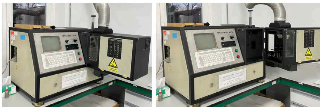
Figura 2-19: Espectrómetro de emisión atómica de electrodo de disco giratorio cerrado (izquierda) y abierto (derecha)
