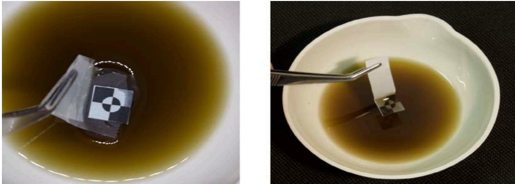
Figura 2-58: Colocación de la trama en el aceite para realizar el enfoque
