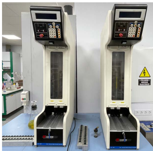
Figura 2-7: Viscosímetro Cannon CAV-2100 utilizado para determinar la viscosidad a 40°C y 100°C
