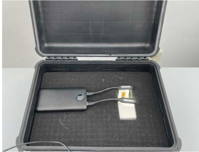
Figura 2-33: Iluminación con dos tiras LED y el uso de batería externa
