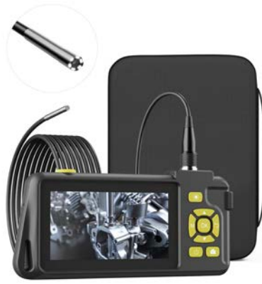
Figura 2-69: Cámara endoscópica (modelo Zealtron Industrial Endoscope 3.9mm)
