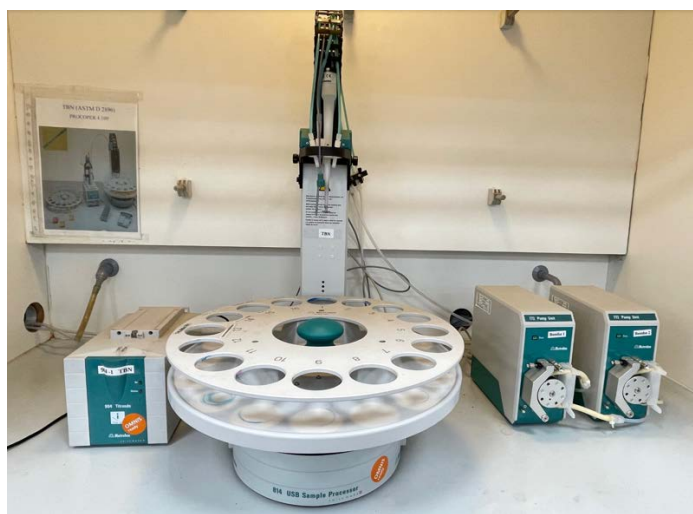
Figura 2-12: Equipo utilizado en la determinación del TBN
