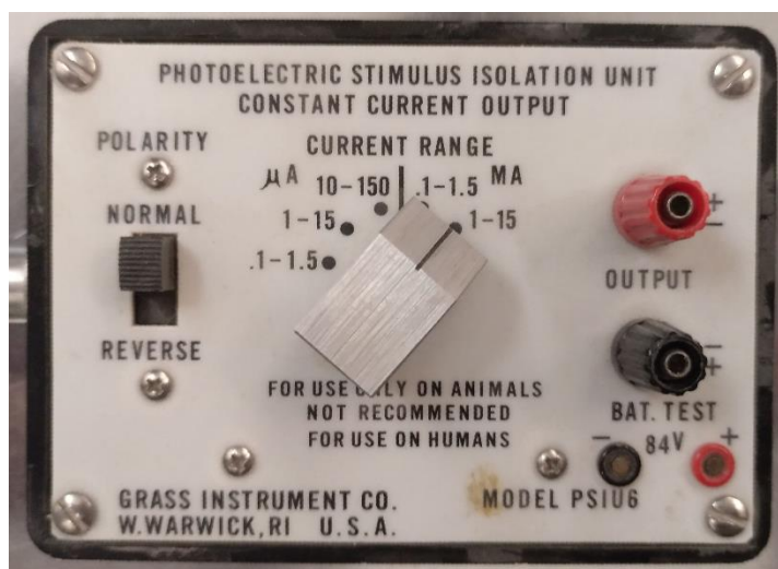
Figura 17: Unidad de Aislamiento PSIU6. Permite modificar la intensidad del pulso proporcionado, así como cambiar su polaridad. Concretamente en la imagen está programada para dar pulsos entre 1 y 15mA y polaridad normal.
