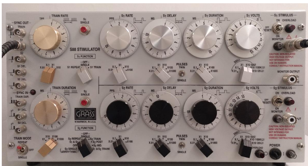
Figura 16: Estimulador Grass modelo S88. En la parte superior se indican las condiciones de estimulación en el protocolo de Intensidades: Rate 0.2Hz, Delay 0, Duration 0.5ms y Volts 7mA (Variable).
