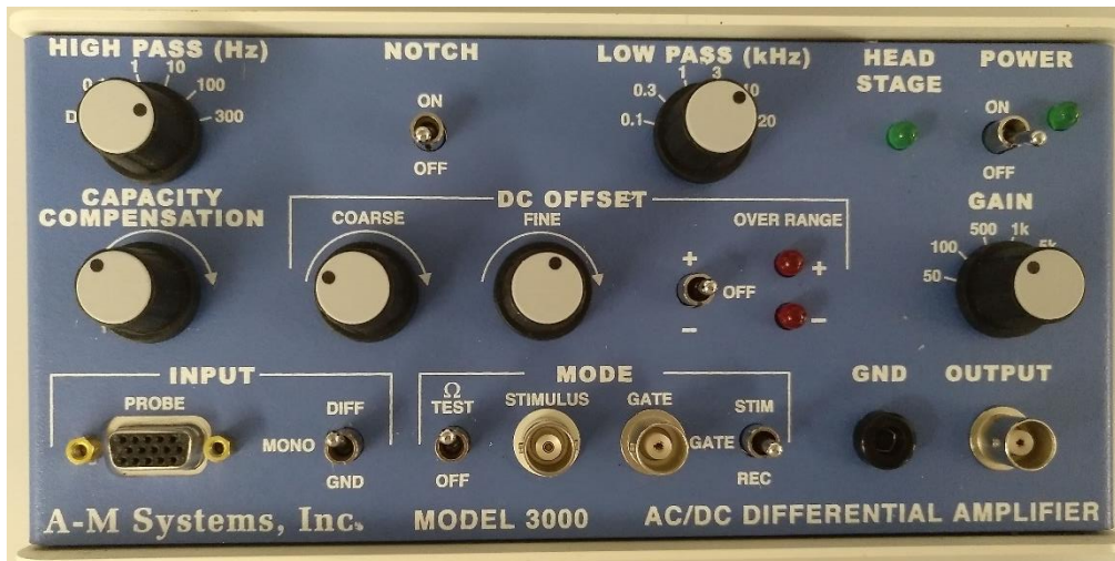
Figura 18: Amplificador AC/DC modelo 3000. Permite amplificar la señal obtenida por los pulsos eléctricos dados.
