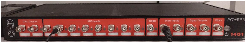
Figura 19: Tarjeta analógico/digital. Permite convertir la información analógica registrada en información digital que se verá reflejada en el software Spike.
