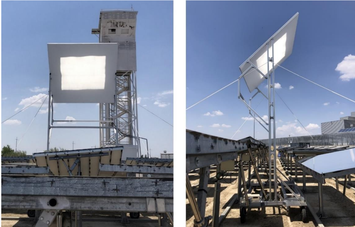
Figura 5.7. Diana móvil empleada para caracterizar la superficie de los heliostatos de la instalación ACES con el ARS.
