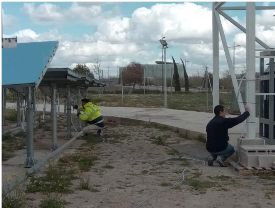
Figura 4.10. Nivel de agua empleado para la determinación de las alturas de los heliostatos.
