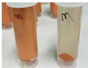
Figura 2.3. Material crudo de nanoesferas de carbono sin centrifugar (izquierda) y centrifugado (derecha).
