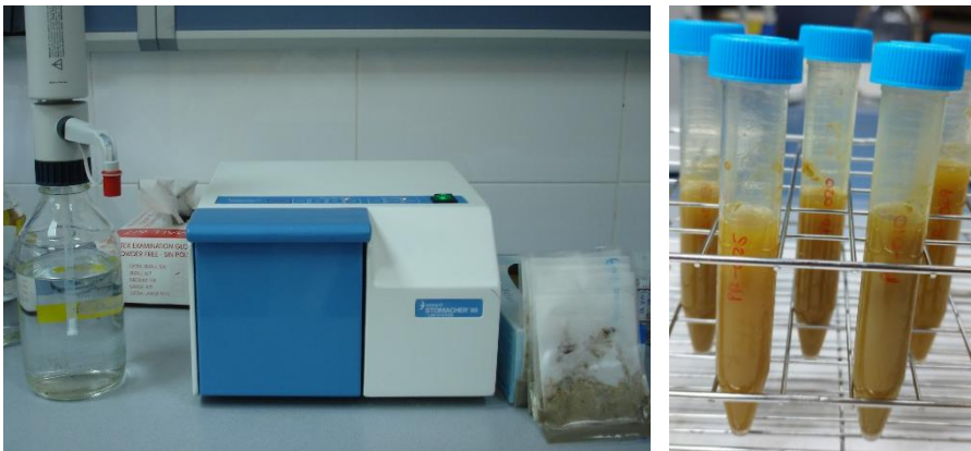
Figura 12. Procesado de muestras. Stomacher 80 Biomaster y bolsas estériles con filtro, a la izquierda; líquido obtenido del macerado conjunto de las abejas, a la derecha. Fuente: original.
