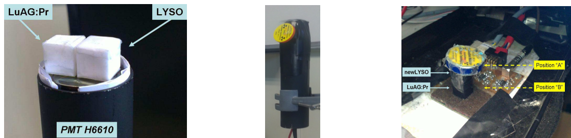
Fig. R.16. Distintas configuraciones de phoswich que fueron testadas, el cual fue acoplado tanto al PMT como a un SiPM.
