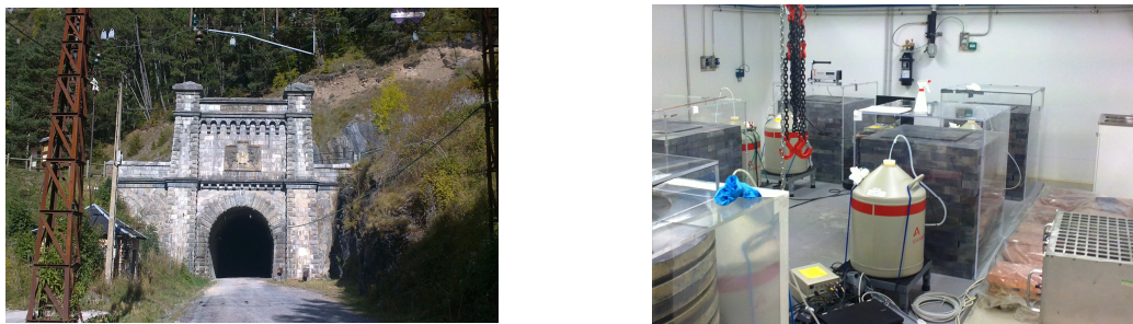
Fig. R.14: Izquierda, entrada secundaria al laboratorio. Derecha, sistema de adquisición basado en HPGe. Se aprecia el castillo de plomo y el encapsulado.
