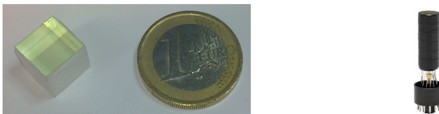
Fig. R.6: Izquierda, cristal cúbico de LuAG:Pr al lado de un moneda de un euro. Derecha, fotografía del R5320 fuera del encapsulado magnético.
