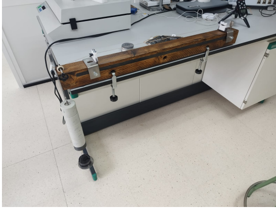
Figura 6: Monocordio, osciloscopio y micrófono empleados en el experimento
