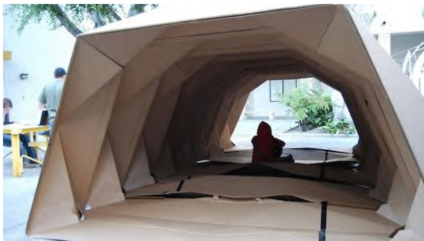
FIGURA 2. Hovsepian, T. (2007). “Cardborigami”. Refugio portátil y temporal de cartón, instalable en menos de un minuto, para las personas sin techo y en caso de desastre
