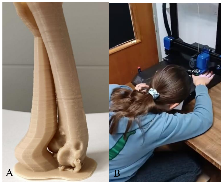
Figura 4.4: (A) Ejemplo de posibles andamios y base para la impresión de fémur de Pigargo Europeo y (B) calibración de la impresora 3D Artillery Sidewinder X2.
