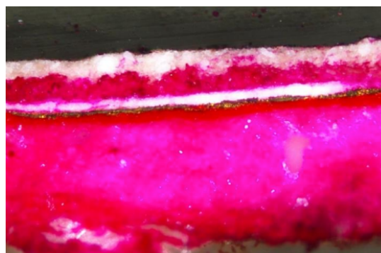
Fig. 22: Análisis estratigráfico teñido con fuschina. El aglutinante proteico del aparejo queda teñido de rosa, mientras que la capa pictórica blanca queda sin teñir. Fuente: Ruth Chércoles.
