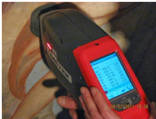
Fig. 25: Equipo portátil de fluorescencia de RX. Fuente: Ruth Chércoles.
