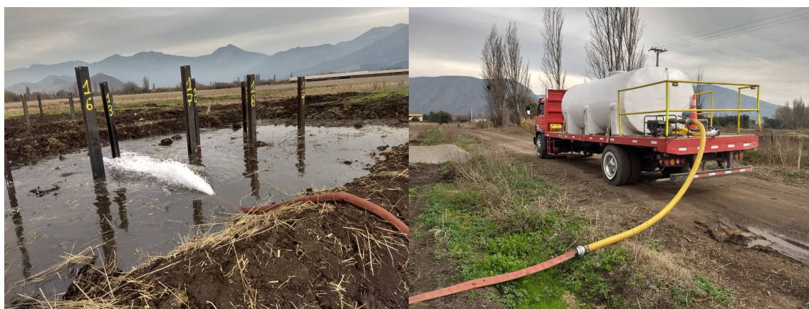
Figura 18 Inundación de un grupo de perfiles con ayuda de una cuba, fotografías cortesía de GEOINTEC
