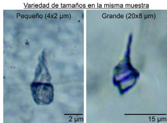
FIGURA 3: Tamaños de referencia (grande y pequeño) para la tipología piriforme (Lopez-Elorza et al. , 2016). Si se encuentran tres inclusiones piriformes con tamaños como 3x1 μm, 4x1 μm o 5x2μm, todas ellas se agruparán en el tamaño “pequeño” y se asimilarán a las mismas dimensiones (4x2 μm) para el cálculo final de área. Las dos inclusiones corresponden a una estalagmita de la Cueva del Tortero, Valencia.
