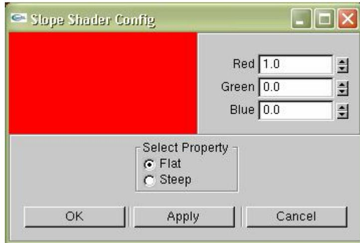
Este shader aplica un color para las zonas planas y otro para las zonas con pendiente. Aplica a las zonas planas el color “Flat” y para las zonas con pendiente obtiene los porcentajes de color “Steep” y “Flat” a aplicar. Cuanto más vertical es una superficie, más porcentaje de “Steep” compone su color. La ventana de configuración permite seleccionar qué dos colores deseamos que el shader utilice.
