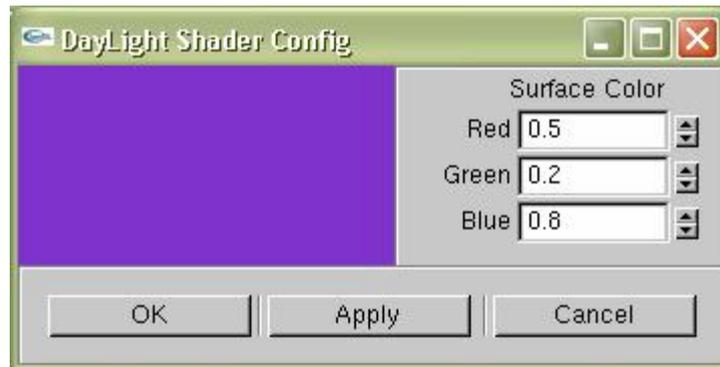
Este shader utiliza un único color que varía en intensidad para dibujar el DEM. En su configuración podemos seleccionar el color de la superficie que se empleará.
