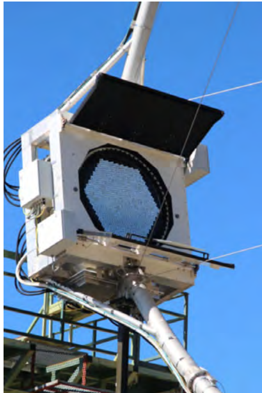
(b) Fotografía de la cámara de uno de los telescopios MAGIC.
