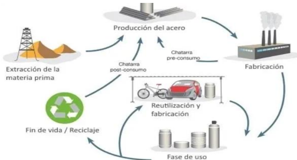
Figura 29: El ciclo de vida del acero. Fuente: AINEnergía (Asociación de Ingenieros de la Energía)
