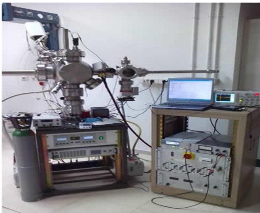
Figura 18: Equipo de pulverización catódica.
