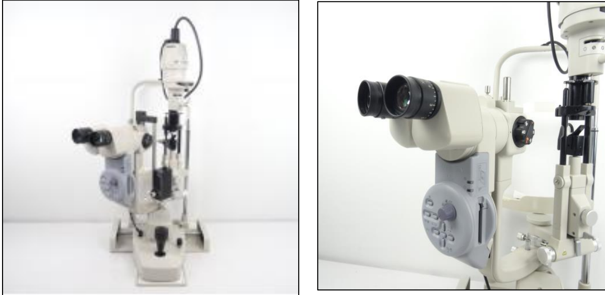
Figura 28. Biomicroscopio o Lámpara de hendidura, modelo DC-3, marca TOPCON. Fuente: TOPCON (111–113).
