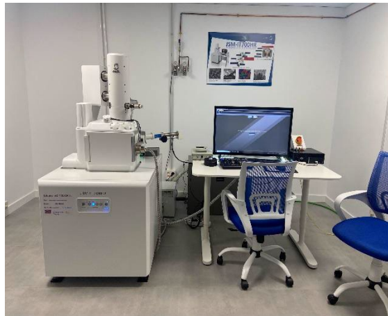
Figura 7. SEM en el Centro de Microscopía electrónica de la UCM, equipo JDM-IT700HR.
