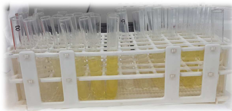
Figura 27. Tubos con las diferentes decoloraciones obtenidas mediante el método de la inhibición de la decoloración del \beta -caroteno (Foto: María Ciudad)
