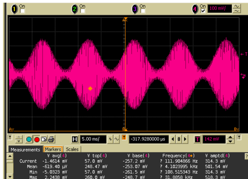
Figura 50: Señal modulada AM sin offset a la entrada del detector (salida del filtro paso alto)
