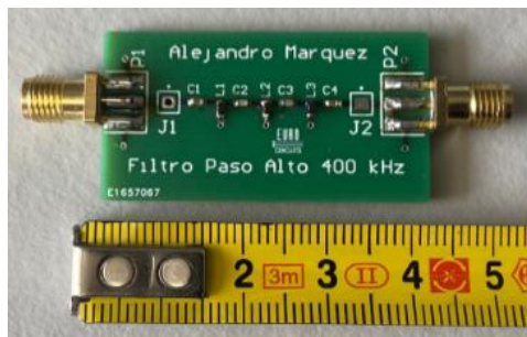
Figura 37: Fotografía de filtro paso alto fabricado
