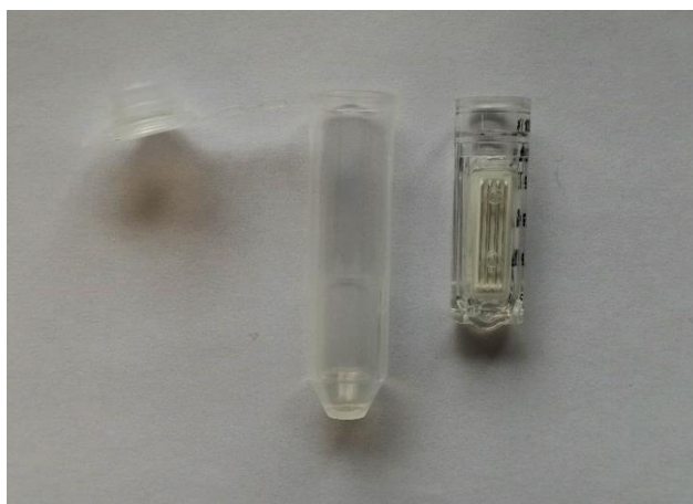
Figura 4.7. Filtro Amicon Ultra 0.5 mL Ultracel 10k.
