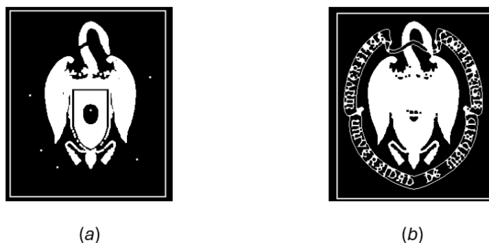
Figura 2.14: (a) Apertura; (b) Cierre. Ambas aplicadas a la imagen de la figura 2.9(a) con el elemento estructural isótropo 3x3 de la figura 2.7(a)
