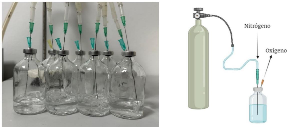
Figura M1. Esquema del proceso de obtención de anaerobiosis. El gas nitrógeno entra en la botella por la aguja más grande y desplaza el oxígeno que sale por la aguja pequeña.
