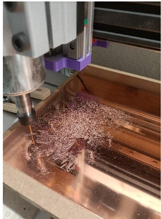
Figura 9. Izquierda: fresadora CNC, prueba con rotulador acoplado. Derecha: fresadora CNC, fresado en plancha de cobre. Fuente: autor
