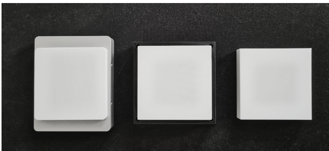
Figura 3.15: Ejemplares de cada tipo de muestra que va a ser caracterizada como patrón del coeficiente de radiancia 0^\circ:45^\circ en este trabajo, de izquierda a derecha: G97, AW1 y ZP1.
