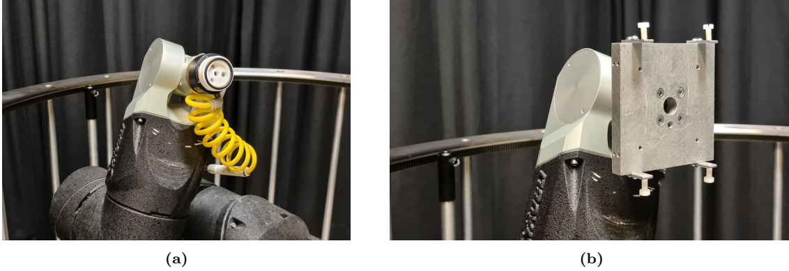
Figura 2.8: Conjuntos de sujeción de las muestras para el brazo robot montados en el GEFE: succión (a) y sujeción mecánica (b).
