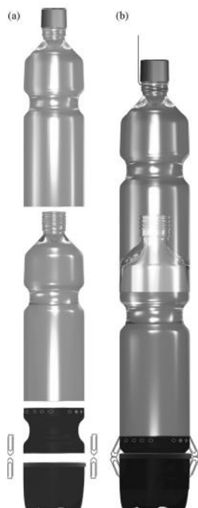
Figura 15. Representación esquemática de una trampa. (a) Componentes individuales de la trampa; (b) Trampa ensamblada. Se colocan trozos de fruta en el fondo pintado de negro de una botella de tereftalato de polietileno (PET) de 1,5 litros y se cubren con una red (media). Se cortan tres pequeñas aberturas de aproximadamente 3 \times 0,5 cm en el extremo oscuro de otra botella de PET y se cubren por una red (malla de 4 mm). La construcción del sistema cónico con la segunda botella de PET que encaja en la parte transparente superior de la primera botella evita que los insectos capturados escapen ya que los insectos tienden a dirigirse hacia la luz. Los sujetapapeles y el cable fijan las dos partes oscuras de la botella. Fuente: Roggero et al. , 2010.
