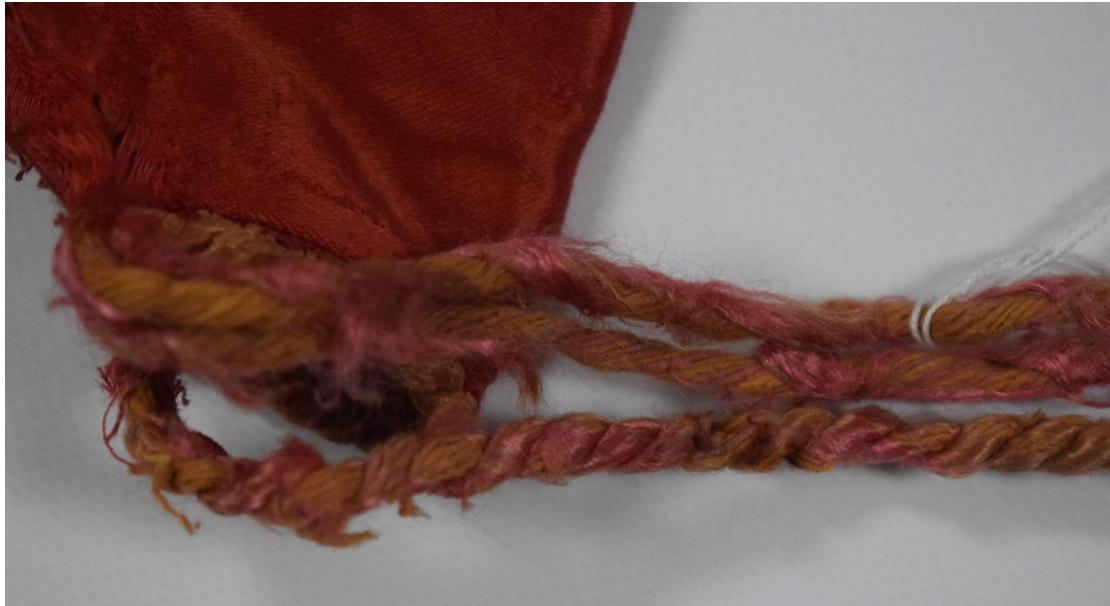
Fig. 61. Estado de conservación del cordón de la bandera. Se aprecian destorsionados, roturas de los hilos y claramente un frágil estado. Fuente propia.
