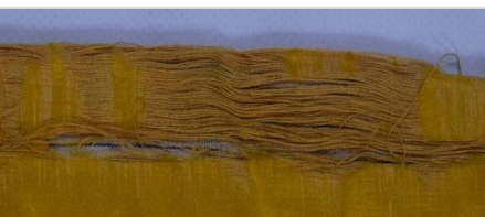
Fig. 30. Rotura y desgarro en la vaina de la bandera. Fuente propia.
