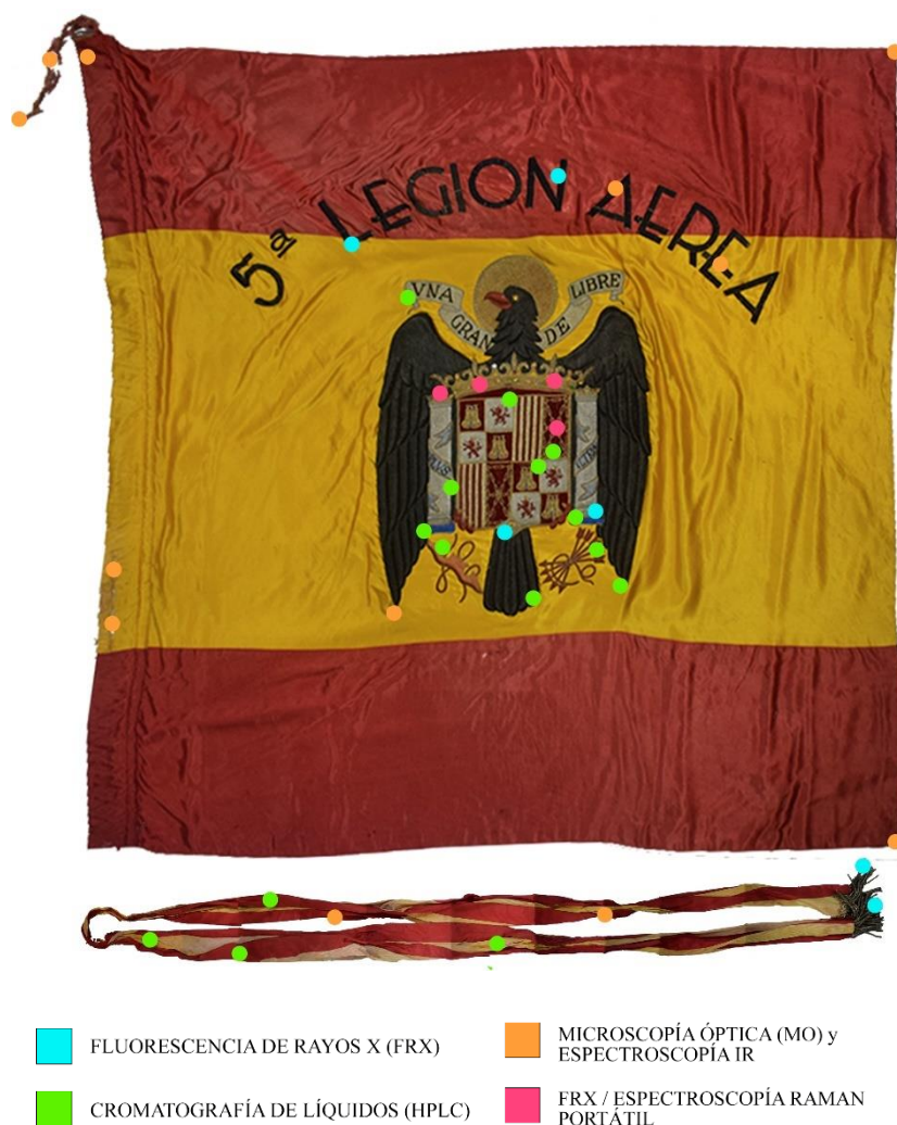
Fig. 33. Esquema de la estrategia de muestreo empleando los diferentes métodos de análisis. Fuente propia.
