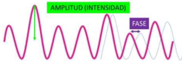
Figura 10: Representación de la onda de luz. Amplitud (intensidad) y fase (decalaje temporal).
