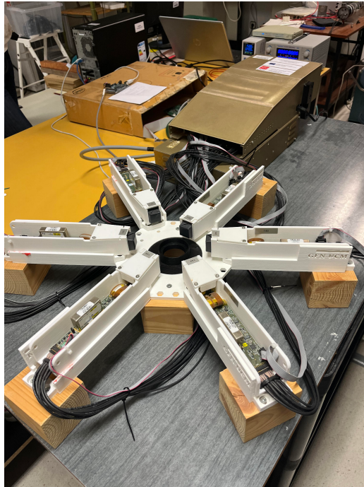
Figura 1. Sistema de detectores para imagen PET montado para las sesiones del laboratorio de bioseñales de la asignatura de bioingeniería
