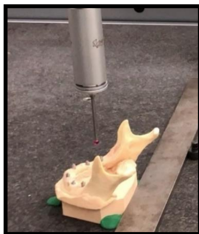
Fig. 8. Registro de superficies mediante palpador mecánico de máquina de medición de coordenadas.
