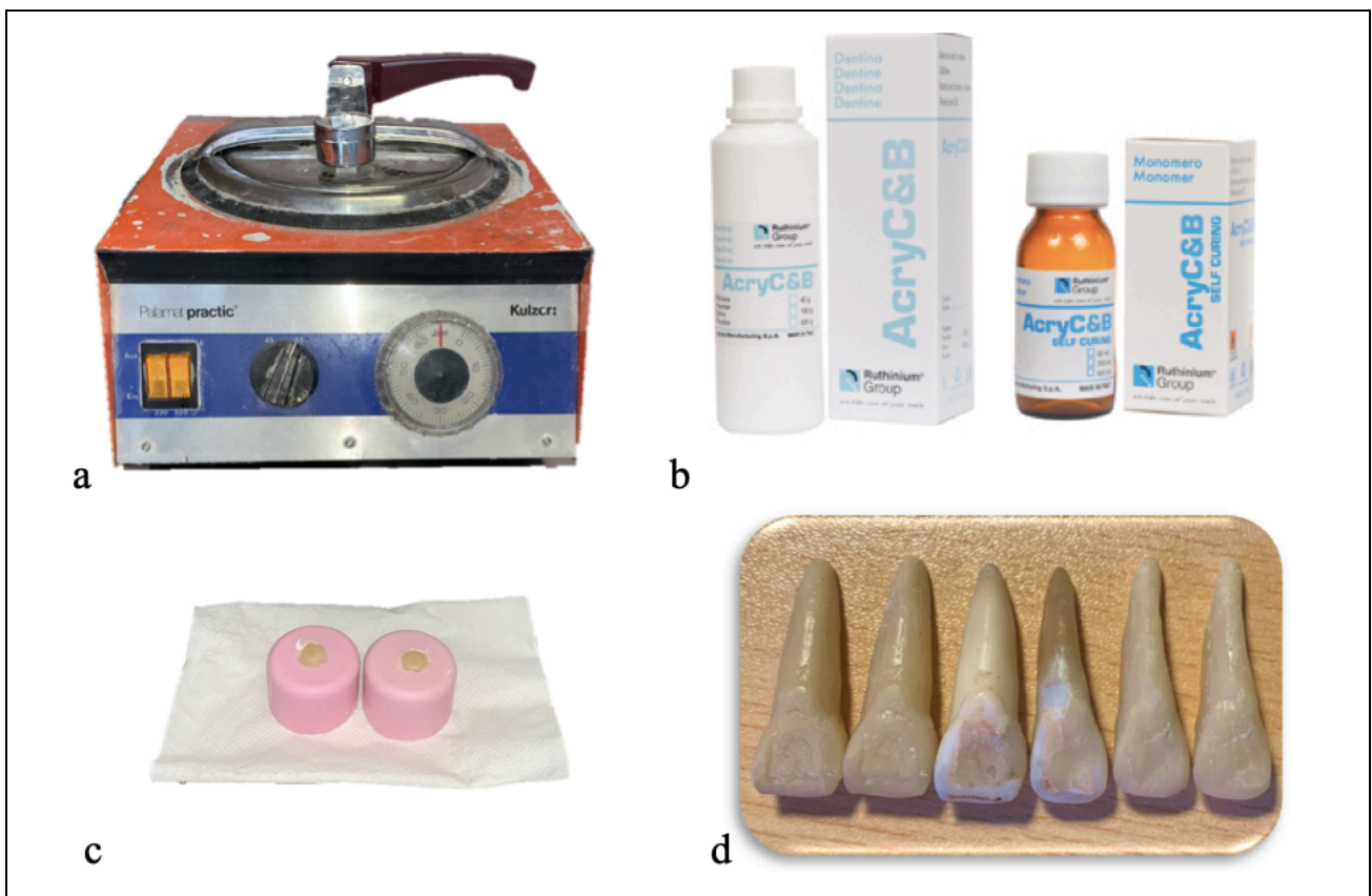
Figura 3. Instrumentos y materiales para la generación de réplicas estandarizadas. (a) Olla de presión para la polimerización. (b) Resina sintética Acry C&B Rx (Ruthinium Group, RO, Italia) radiopaco y un líquido autocurativo. (c) Moldes de silicona Hydorise de alta precisión (Monophase, Zhermack, RO, Italia). (d) Piezas dentales que sirvieron de patrón junto con sus réplicas sintéticas.
