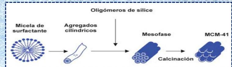
Figura 2. Mecanismo de síntesis de materiales mesoporos de sílice empleando surfactante [2]
