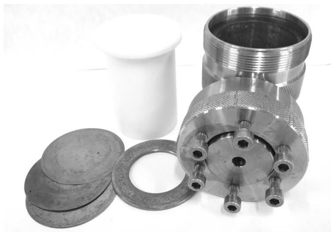
Figura 3. 3. Reactor autoclave utilizado en la síntesis hidrotermal de los sistemas compuestos.
