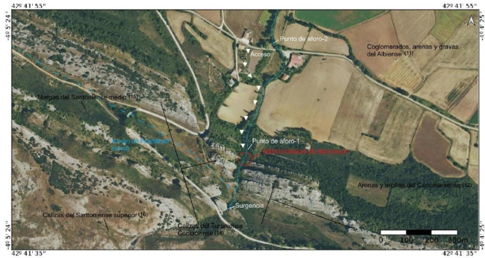
Figura 20. Ubicación de manantial de Barriolucio. El acceso a la surgencia se indica con flechas blancas. Coordenadas de punto de aforo 1 y 2 (ETRS89): 411368.161, 4727533.400 y 411459,40, 4727865,07. Surgencia: 411319,76, 4727394,68. Los números hacen referencia a las formaciones geológicas de la hoja MAGNA – 134 (Anexo II, figura II.2). Fuente: Elaboración propia.
