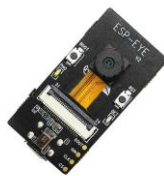
Figura 1-4. ESP-EYE capaz de tomar una imagen y enviarla para su procesamiento
