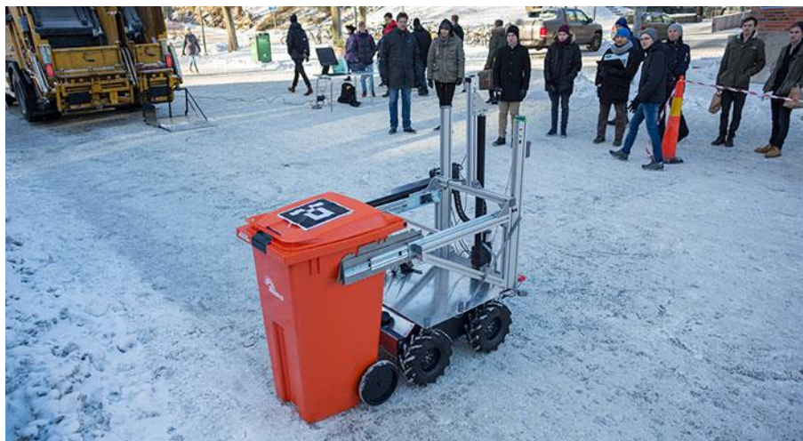
Figura 1-2. ROAR - El robot recolector recibe las coordenadas del cubo a recoger
