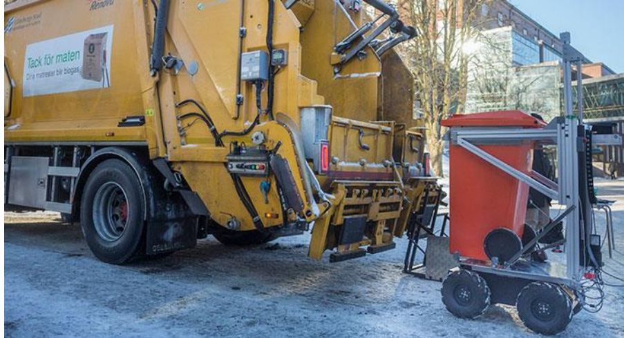
Figura 1-3. ROAR - El robot deposita el cubo en el camión para su vaciado
