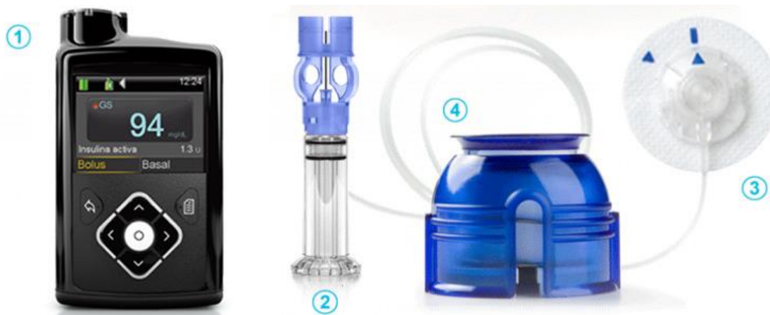
Figura 1. Componentes de la bomba de insulina 17 .
