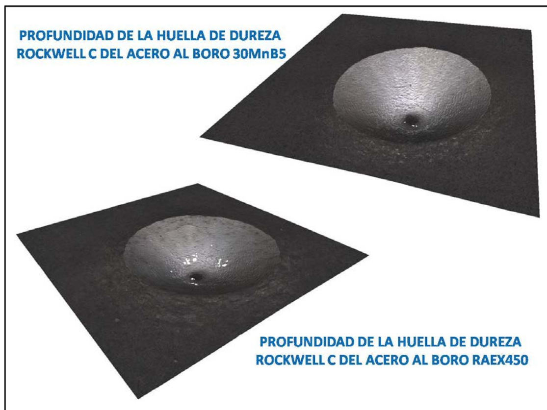
Figura.19: Profundidad de las huellas de dureza Rockwell C realizada en los dos tipos de aceros al boro.
