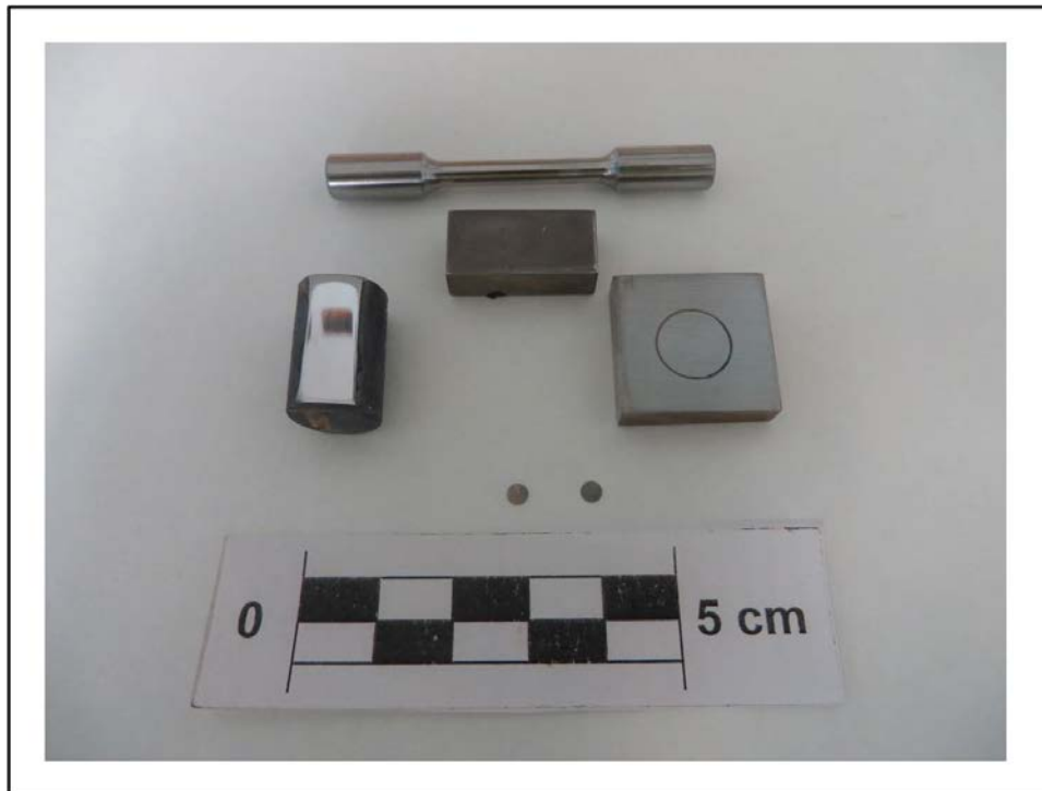
Figura.11: Imagen de las probetas de acero al boro 30MnB5 y RAEX450 utilizadas.
