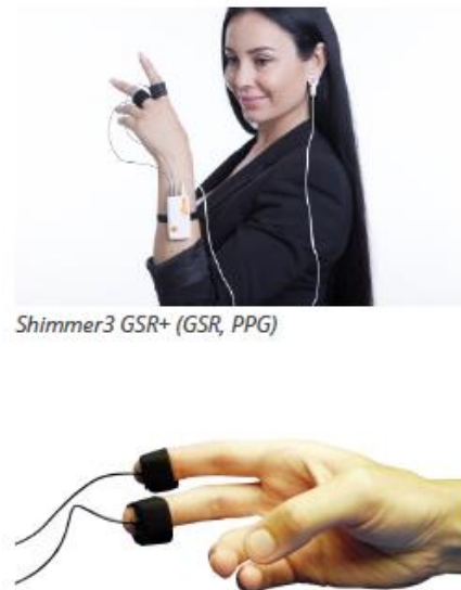
Figura 14. Electrodoos GSR: distintas formas de colocar en un sujeto.
