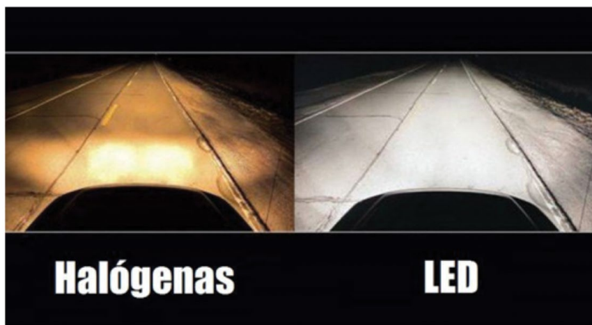
Figura 1: Comparación de la intensidad de un faro tradicional halógeno frente a un faro LED.
