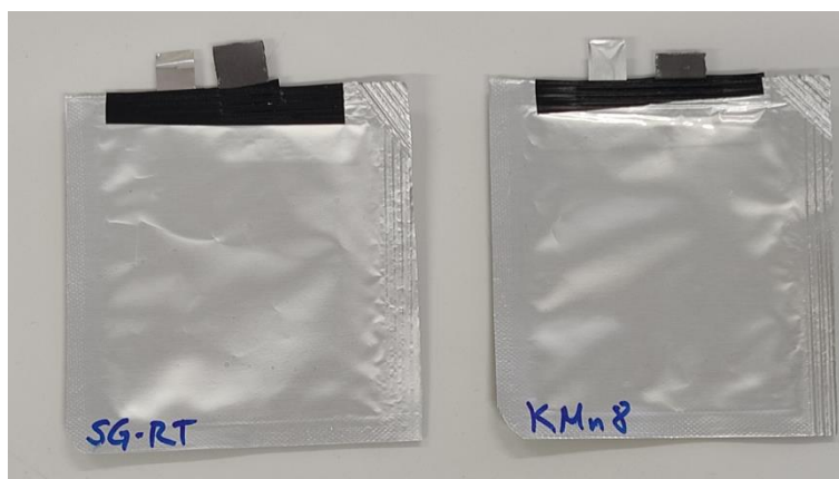
Figura II - 16. Celdas finales con electrodos positivos compuestos de las muestras con estructura tridimensional ( \alpha - \text{MnO}_2 ) y laminar ( \delta - \text{MnO}_2 )
