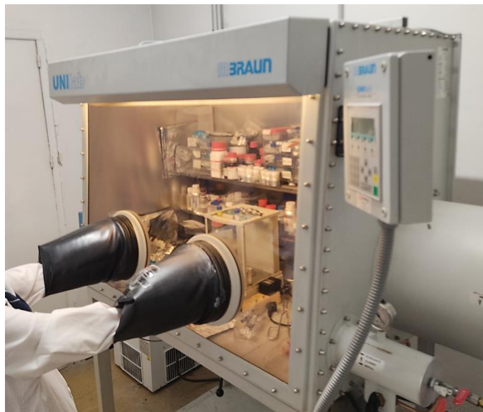
Figura II - 9. Equipo caja de guantes con atmósfera controlada de argón ( 1 < \text{ppm de O}_2 y 1 < \text{ppm de H}_2\text{O} ).
