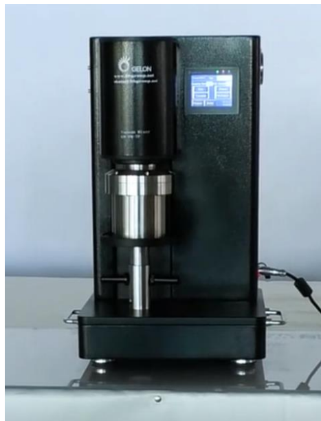
Figura II - 11. Equipo de mezclador del slurry para la homogeneización del composite previo a su laminación sobre el colector de corriente.
