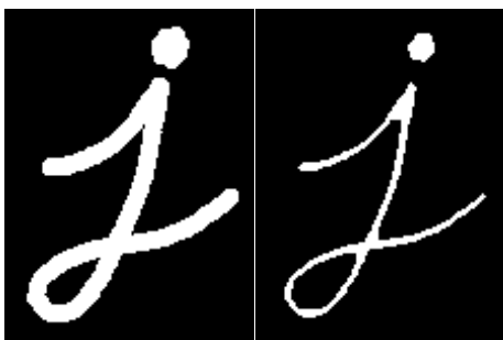
Figura 3.7 Transformación morfológica: Erosión. Fuente: (Open CV, 2025)
