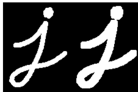
Figura 3.8 Transformación morfológica: Dilatación. Fuente:(Open CV, 2025)
