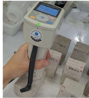
Figura 10. Realización de las medidas sobre la cara x de las muestras de mortero ensayadas con el espectrofotómetro KonicaMinolta CM-700D/600
