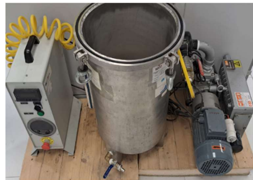
Figura 12. Cámara de vacío empleada en el ensayo de saturación.
