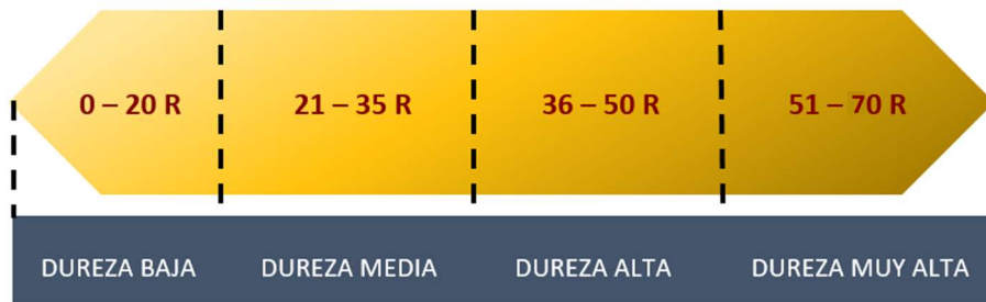
Figura 13. Esquema de la resistencia al rebote de un material pétreo en unidades de Schmidt (R) y con su equivalencia cualitativa en dureza.
