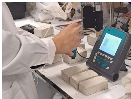
Figura 14. Toma de medidas de la resistencia al microrrebote con el microdurómetro Equotip ®3.
