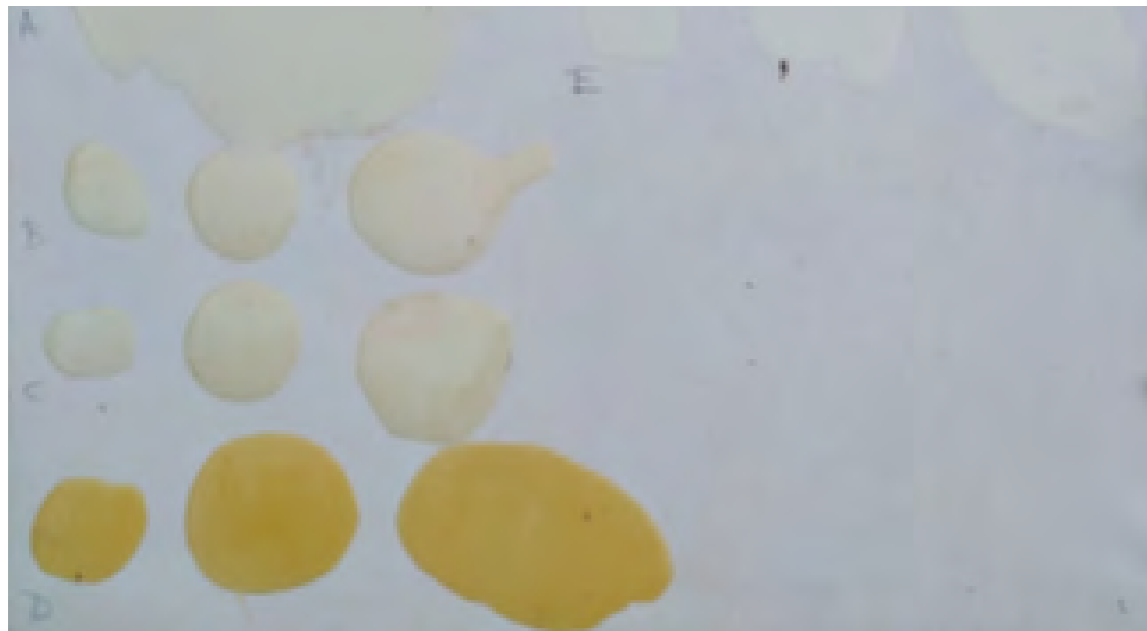
Figura 3 Amarilleamiento tras 12 meses de exposición directa a la luz solar.
