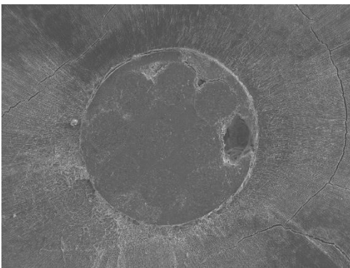
Imagen 372: Muestra 14, corte apical, x50, técnica de electrones secundarios
