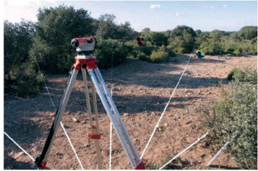
Figura 2.- Disposición del nivel topográfico en el centro del modelo circular generado para la prospección. Se superponen a la fotografía los ejes que delimitan los sectores.
