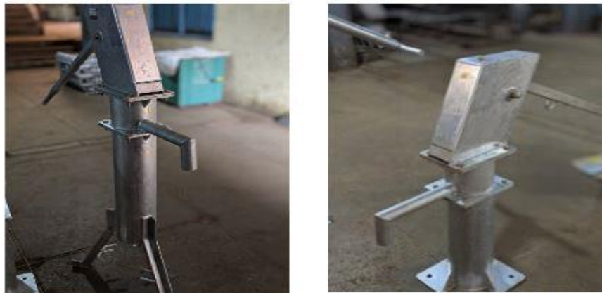
Ilustración 13. Esquema de la bomba de extracción Mark III, que puede ser manual o motorizada, y puede bombear hasta una profundidad de 50 metros, es evolución de la Mark II, una bomba manual de bombeo muy extendida (SK, s.f.).
