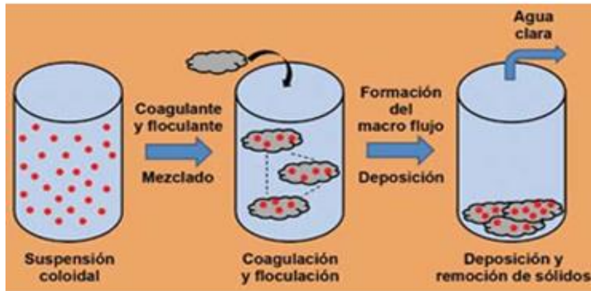
Ilustración 14. Esquema del proceso de coagulación-floculación. (htt3).
